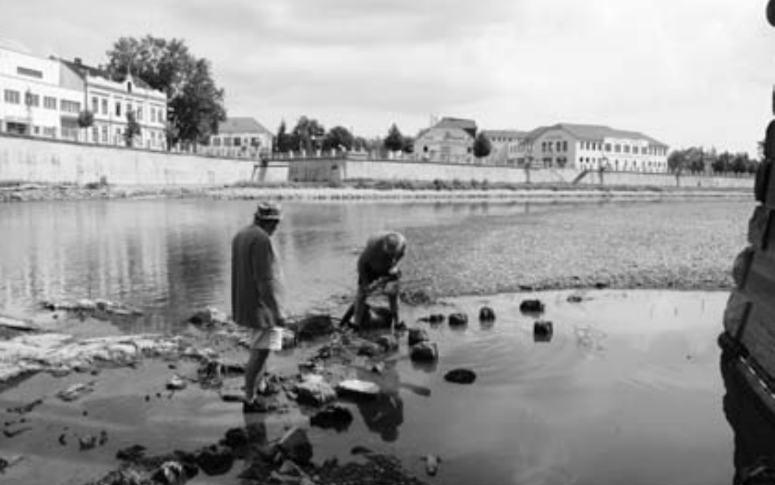
Obr. 18 Odběr vzorků dřevěných pilotů za dna koryta řeky Bečvy (foto. Z. Schenk)
